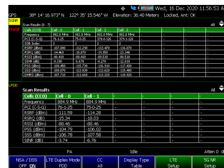
Динамическое распределение спектра (DSS) 5G в канале LTE Вверху: сканирование канала 5G NR с идентификаторами сот Внизу: сканирование канала LTE с идентификаторами сот
