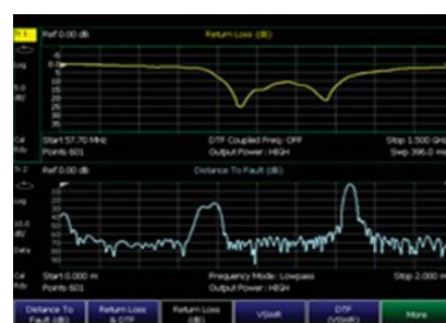
Одновременное отображение обратных потерь и расстояния до неоднородности
