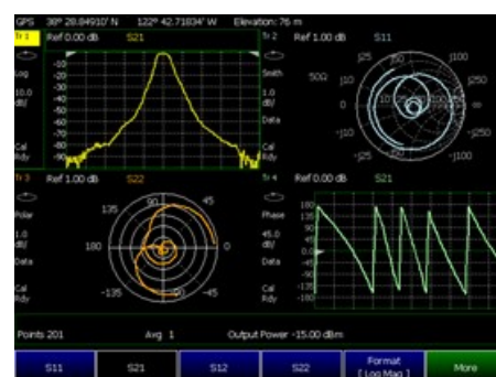
Одновременное измерение и отображение всех четырех S-параметров за одно подключение
